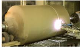
炉内ロール(ハースロール)
