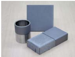
放射線遮蔽・環境調和性コーティングを施工したステンレス円筒管、炭素鋼平板、コンクリートブロック
