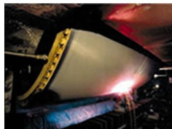
溶射加工中のヤンキードライヤーロール
