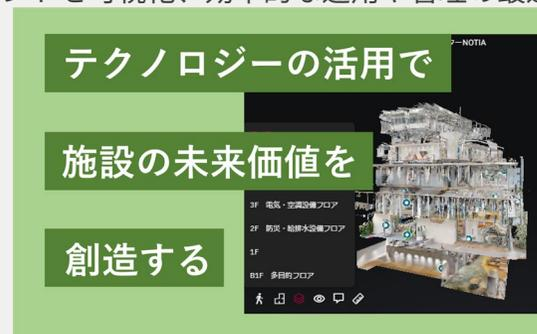
\*Building Information Modelingの略で、コンピュータ上に作成した主に3次元の形状情報に加え、室などの名称・面積、材料・部材の仕様・性能、仕上げなど、建築物の属性情報を併せ持つ建築物情報モデルを構築するもの
