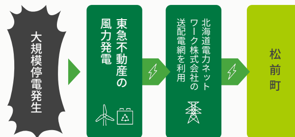
北海道松前町における地域マイクログリッドの仕組み
