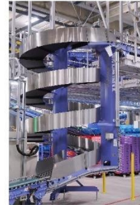
スパイラルコンベア
