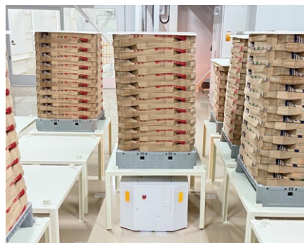
ロボットが自動で包装資材を搬送する様子
