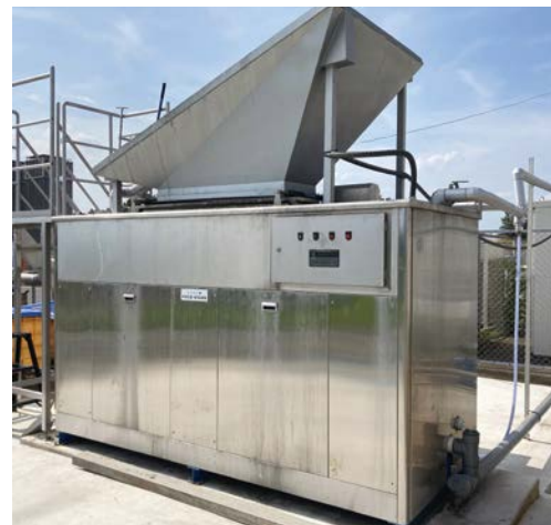
工場敷地内に設置した食品廃棄物の肥料原料化設備 ジョイアス・フーズ児玉工場
