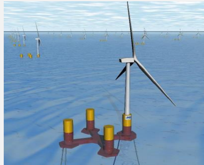
セミサブ型浮体基礎 (画像提供: ジャパン マリンユナイテッド株式会社)
