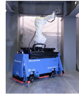
半乾式耐火被覆 吹付ロボット Robo-Spray
