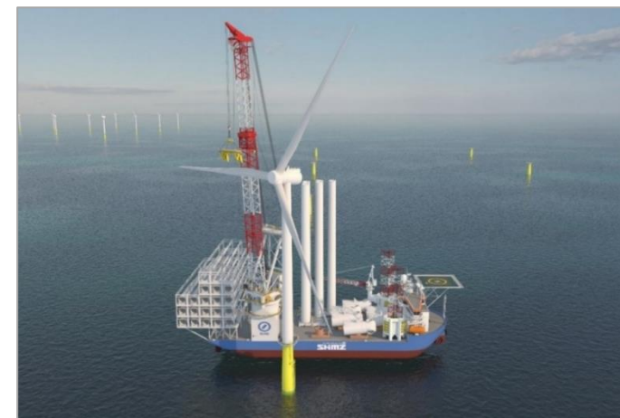
※SEP船：Self Elevating Platform 自己昇降式作業台船 (2020年度分)
