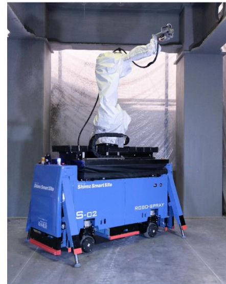
アウトリガーを張り出したRobo-SprayII
