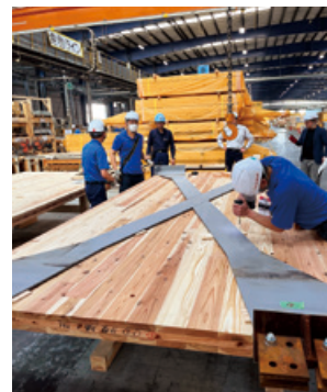
工場で製作したハイウッドウォールを現場に取り付け
