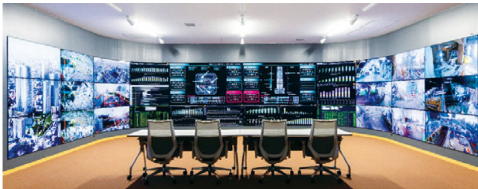
統合監視室ではタワークレーン、工用エレベーターの稼働状況などを具体的なデータと映像でリアルタイムに監視が可能
