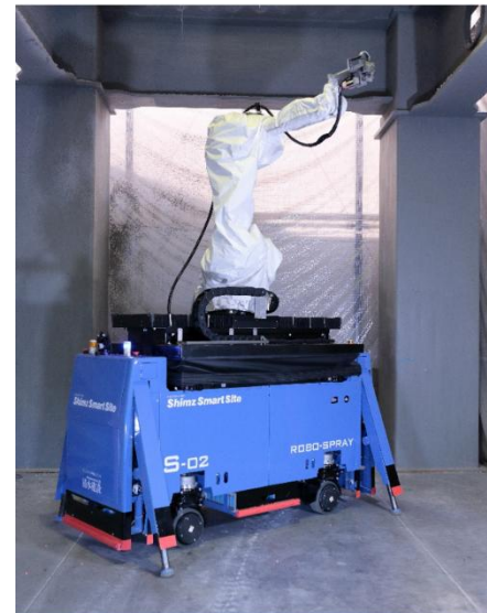
アウトリガーを張り出したRobo-SprayII
