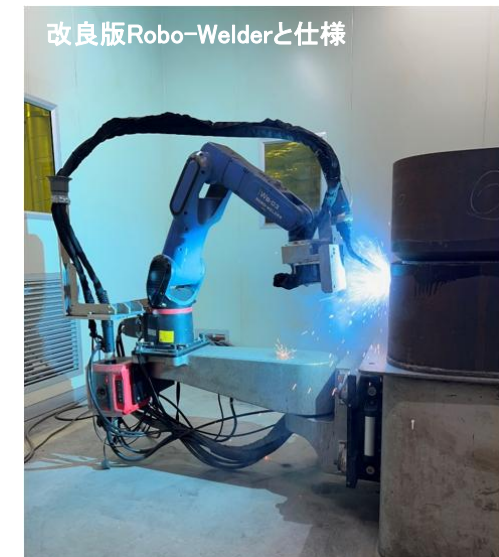
【実験中のRobo-Welder】鉄骨柱から伸び出したシルバーの部位が旋回式台座
