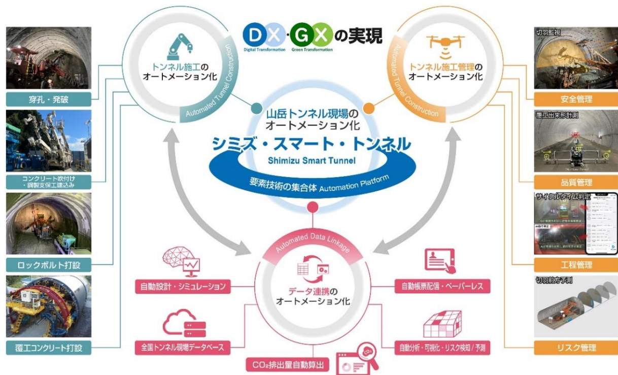
ICTやロボットを活用したトンネル施工システム（一例）
