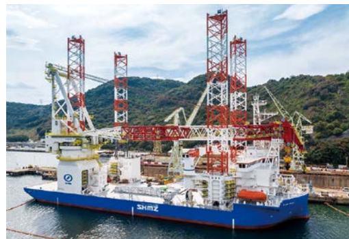
自航式SEP船 ® 「BLUE WIND」 ※Self-Elevating Platform: 自己昇降式作業船
