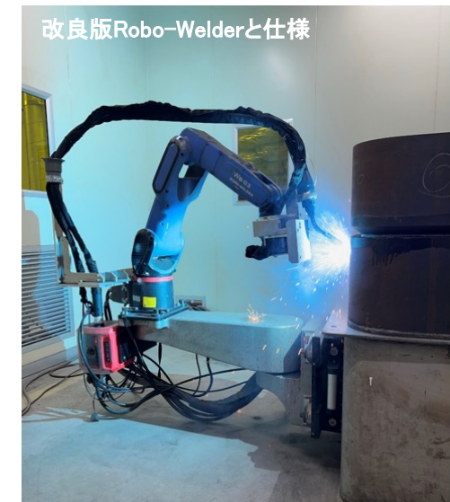
【実験中のRobo-Welder】鉄骨柱から伸び出たシルバーの部位が旋回式台座
