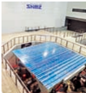
大型振動台 [E-Beetle]。最大搭載重量70トン、加速度2.7G (35トン搭載時)、水平方向最大振幅±0.8m
