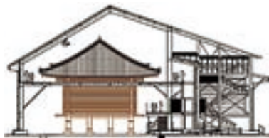
素屋根断面図。間口48m、奥行35m、高さ19m
