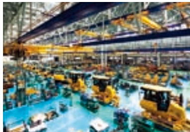
クローラー式車両の組立ライン。設備や配管類がピット内に配置されているため、広々とした作業スペースとなっている
