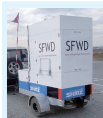
SFWD（Super Falling Weight Deflectometer）とそのシステム概要
