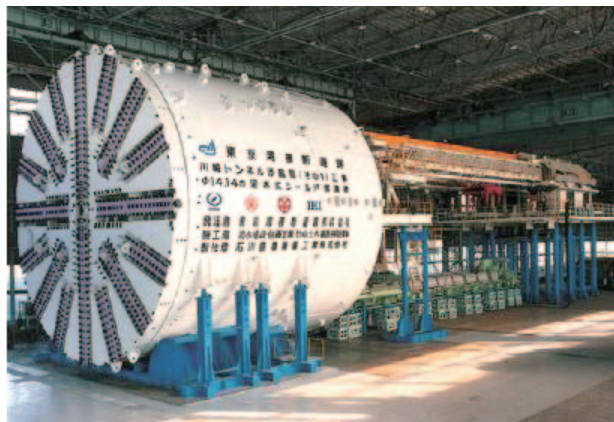
1997年8月竣工の東京湾横断道路の工事で使用したシールド機（当社は同工事で川崎トンネル浮島南工区をJV代表企業として担当）
