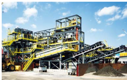
オンサイト型土壌洗浄プラント(小規模案件対応フルスペック機)
