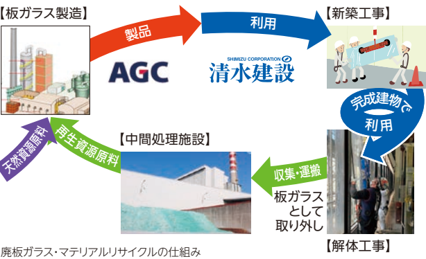
廃板ガラス・マテリアルリサイクルの仕組み
