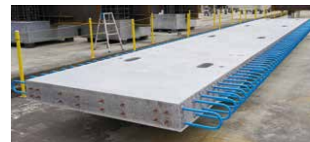
完成したPC道路橋床版
