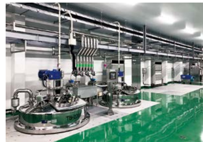
ヤマサ醤油滋賀竜王工場 製造タンクおよび自動原料供給設備
