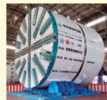
本工事で使用されたシールド機
