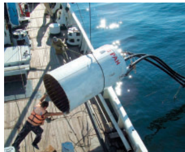
掘削・攪拌用のウォータージェットノズル32本を装着した筒状のチャンパー。鋼鉄製で直径1.2m、高さ2m、重さ約840kg（写真提供：北見工業大学）
