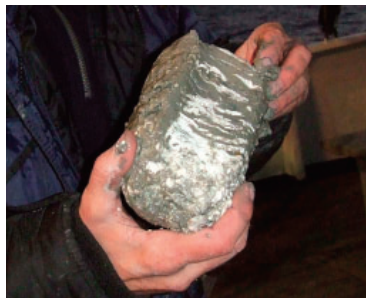
バイカル湖の湖底表層部に含まれていたメタンハイドレート。今回の実験で約100分間攪拌した結果、回収できたガスの90%がメタンやエタンなどの炭化水素ガスと確認された（写真提供：北見工業大学）
