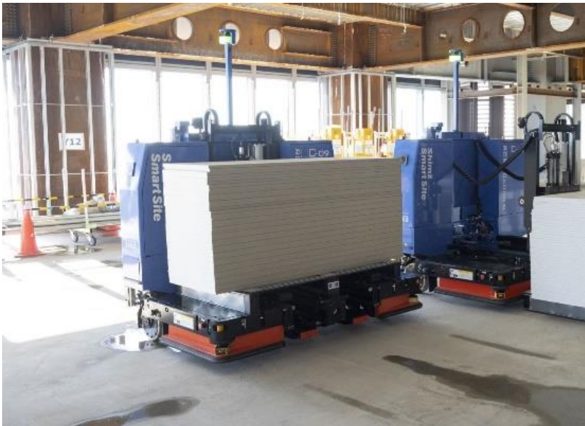
資材の搬送効率を向上させる「Robo-Carrier」
