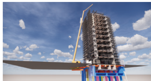
仮設計画を含む統合BIMモデル
