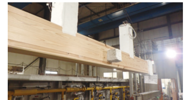
「モクタスWOOD（準耐火）はり」加熱試験体
