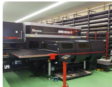
ファイバーレーザ複合機 型式 ACIES12TAJ アマダ製 サイクルローダ 型式 LA2512NTK+SR2512NTK アマダ製
