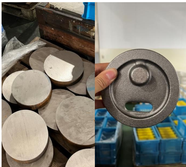
↑左側が丸材、右側が鍛造材
