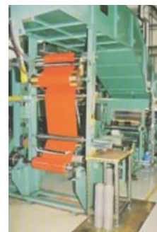
<1970年頃の自動コーティングマシン (巻箔)>
