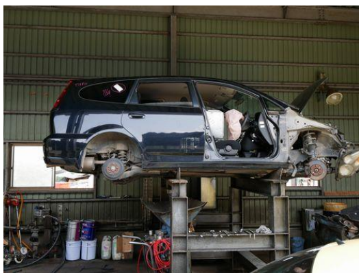
廃オイルの抜き取り作業
