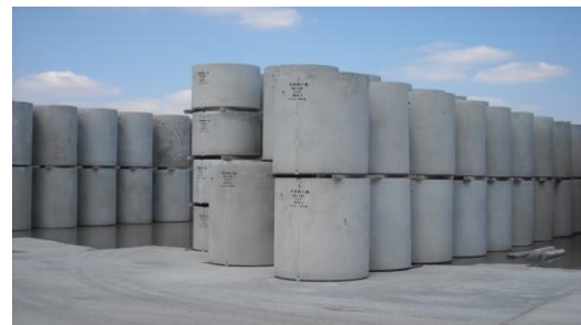
ラダホール直壁（マンホール）
