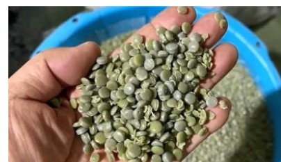
色・柄・文字入りの使用済みクリアホルダーで製造した再生ペレット(再生材)
