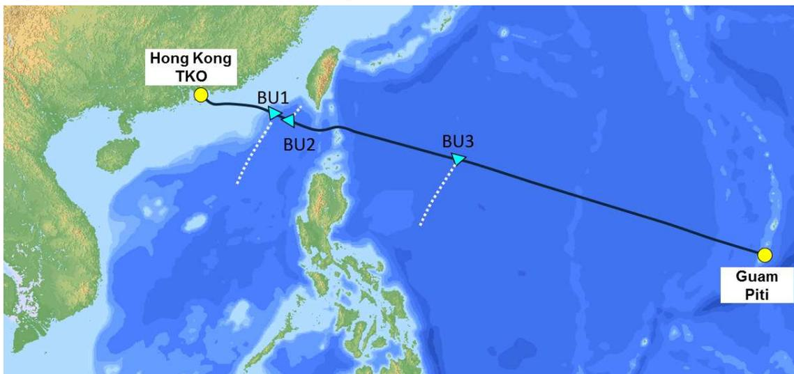
(注) 図中の黒線は今回敷設するケーブル。BU1~3 は将来の延伸を想定して設置する分岐装置。
