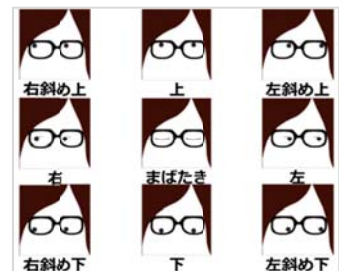
(図 3) 八方向の視線移動とまばたきがリアルタイムで測定できます
