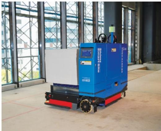
天井ボード（約1 t）を搬送するRobo-Carrier（水平搬送ロボット）
